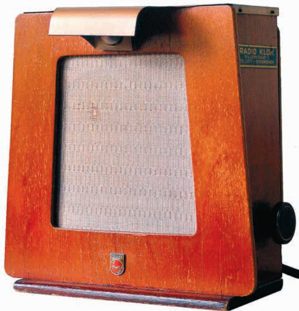
Philips 37A (Luistervink), ontwikkeld voor het beluisteren van de zender Herrijzend Nederland. De ontvanger is vast ingesteld op Radio Herrijzend Nederland. Een afstemknop, afstemschaal en aan/uit-schakelaar ontbreken. Foto: John Hupse.
